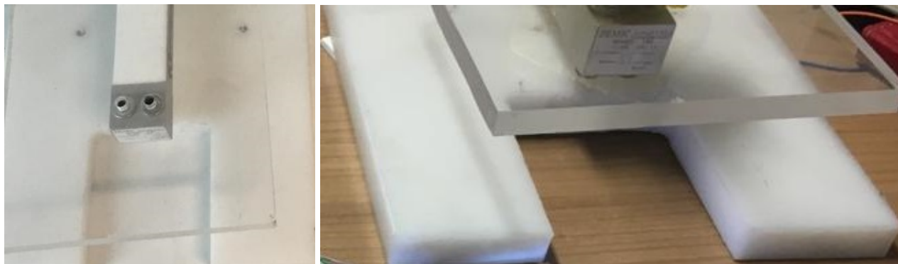
Resim 1. Hassas Terazinin alt ve üst tabla görünüşleri
