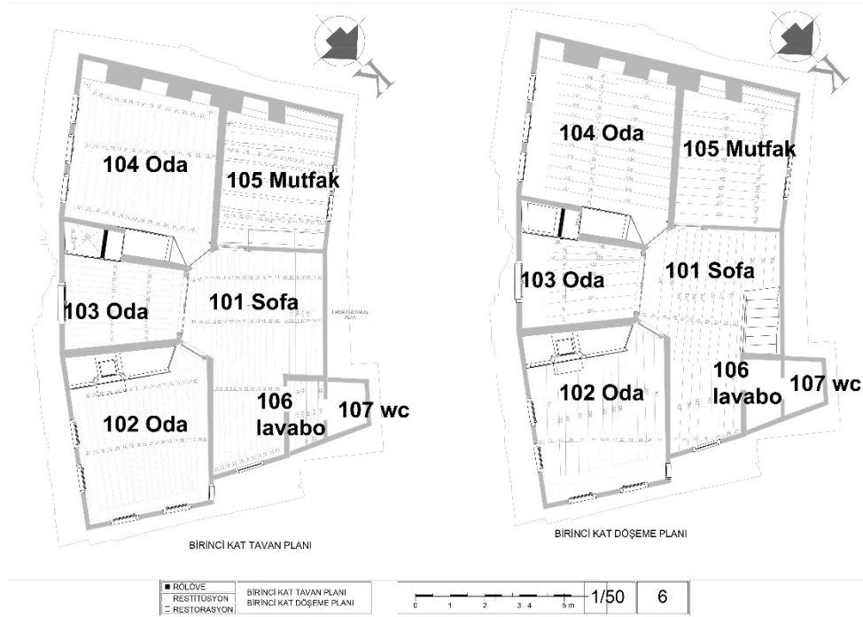
Şekil 5. Birinci kat tavan ve döşeme plan rölövesi, Çizen: Yazarlar (2022)
