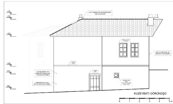
Şekil 33. Kuzeybatı cephe restorasyon çizimi, Çizen: Yazarlar (2022)
