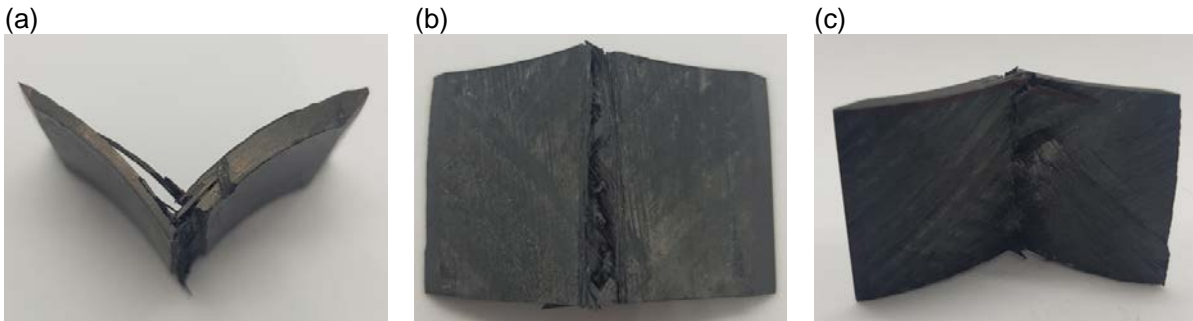
Şekil 9. Üç hafta yaşlandırma işlemine maruz bırakılmış saf epoksi kompozit numunelerin (a) kesit alanı darbe hasar görüntüsü, (b) iç yüzey darbe hasar görüntüsü, (c) dış yüzey darbe hasar görüntüsü
