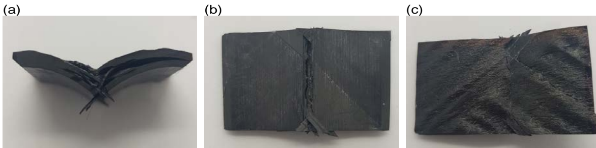
Şekil 6. Yaşlandırma işlemine maruz bırakılmamış saf epoksi kompozit numunelerin (a) kesit alanı darbe hasar görüntüsü, (b) iç yüzey darbe hasar görüntüsü, (c) dış yüzey darbe hasar görüntüsü
