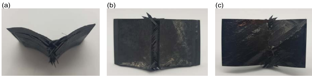
Şekil 7. Bir hafta yaşlandırma işlemine maruz bırakılmış saf epoksi kompozit numunelerin (a) kesit alanı darbe hasar görüntüsü, (b) iç yüzey darbe hasar görüntüsü, (c) dış yüzey darbe hasar görüntüsü
