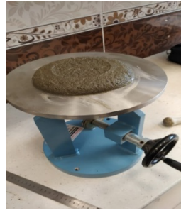
Şekil 1. Geopolimer taze harç kıvamının belirlenmesinde kullanılan yayılma tablası
