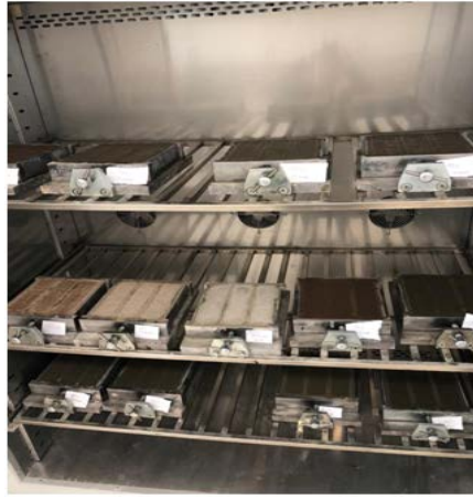
Şekil 3. Geopolimer numunelere 80°C'de farklı sürelerde kür uygulaması
