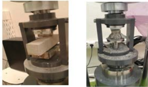
Şekil 4. Geopolimer numunelerin mekanik testleri
