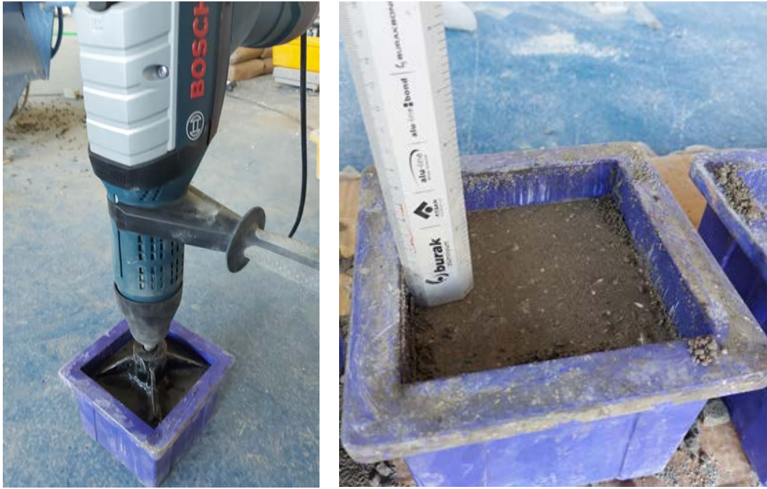
Şekil 2. Titreşimli çekiç ile sıkıştırma işlemi ve sıkışma miktarının ölçülmesi
