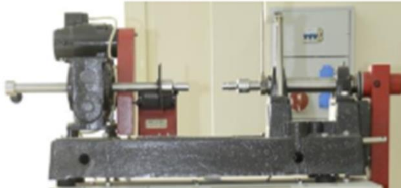
Şekil 6. Shimadzu AG – X marka burulma cihazı
