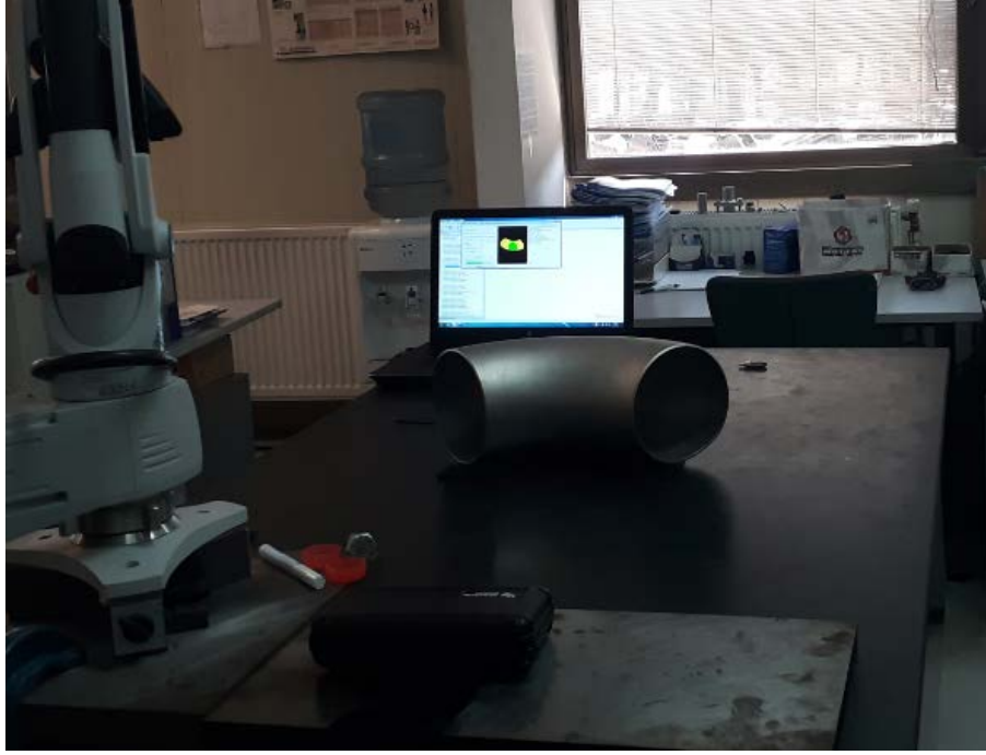
Şekil 4. Lazer Optik Ölçüm Cihazı ile Ölçüm
